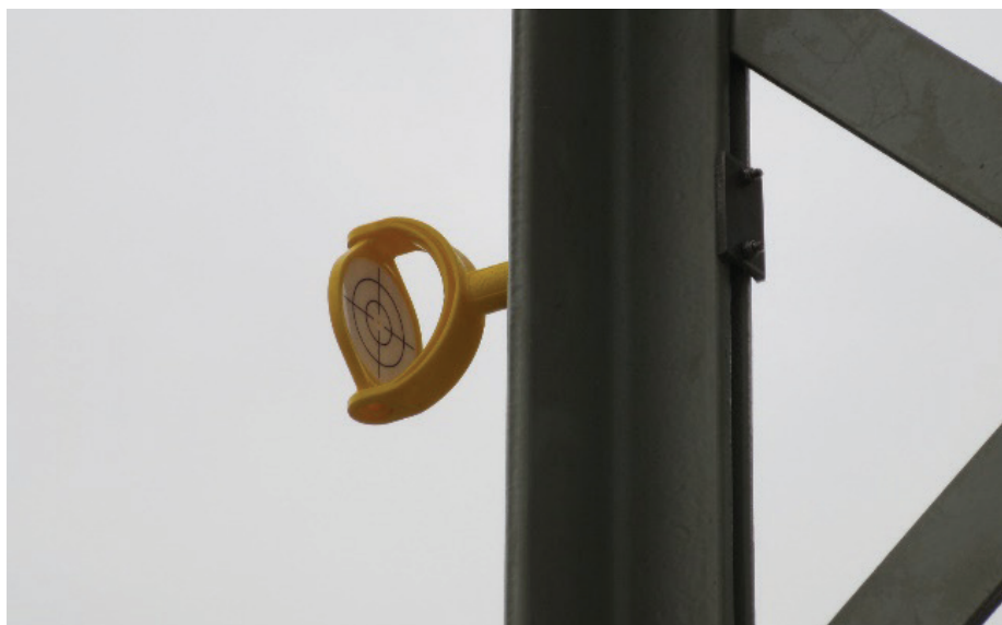
Slika 15 • Tarča za geodetske meritve pomikov na mestih vertikal.
