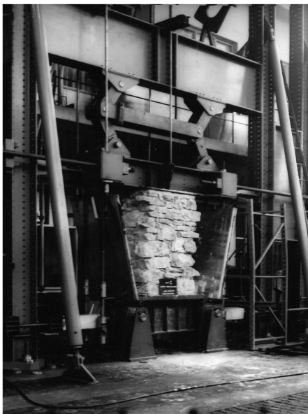
Slika 1. Preiskava kamnitega zidu po potresu na Kozjanskem leta 1974. Levo: zid v preizkuševalni napravi, desno: učinek injektiranja [Terčelj, 1976]
